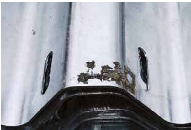
Непроцинковка из-за нанесения маркировки, самоклеющихся бирок
