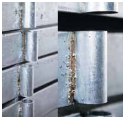
Не зачищенные сварные швы
