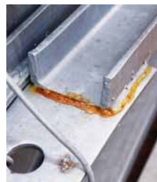
Прерывистый сварочный шов
