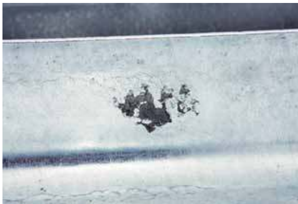
Непроцинковка из-за силиконовой смазки
