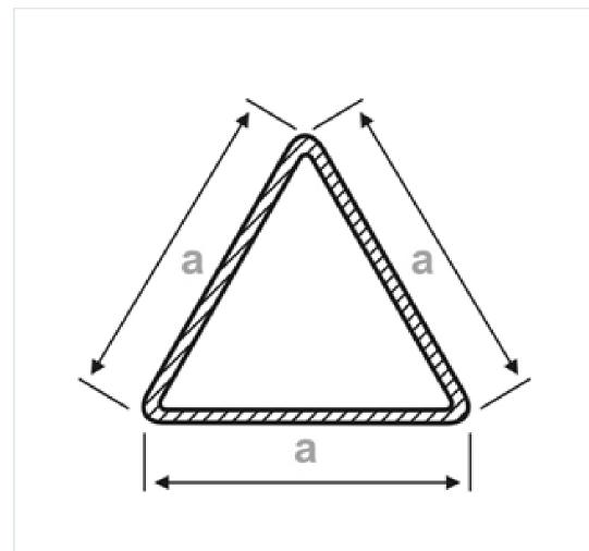
Труба треугольная равносторонняя - это изделие из металла, полое, имеющее треугольное сечение. Главное преимущество данного вида проката - легкий вес, стойкость к длительным статическим нагрузкам, высокая прочность, инертность к воздействию высокого давления. В основном используются в строительстве для создания каркасов.
