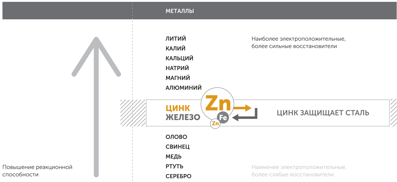
рисунок 2. ПОЛОЖЕНИЕ Zn в электрохимическом ряду напряжений металлов
