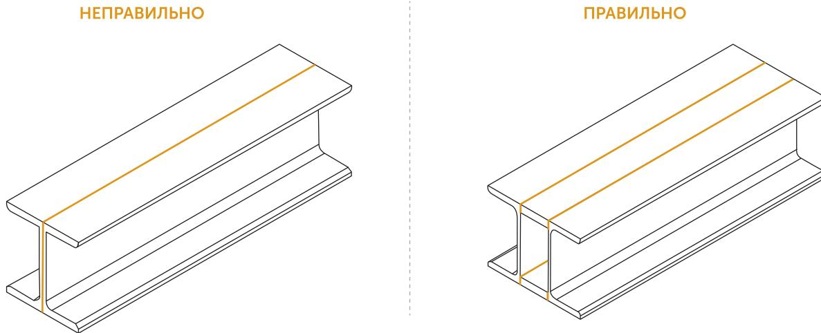
Сварные швы нахлесточных соединений рекомендуется выполнять прерывистым швом при условии гарантированного зазора не менее 4 мм между элементами.
