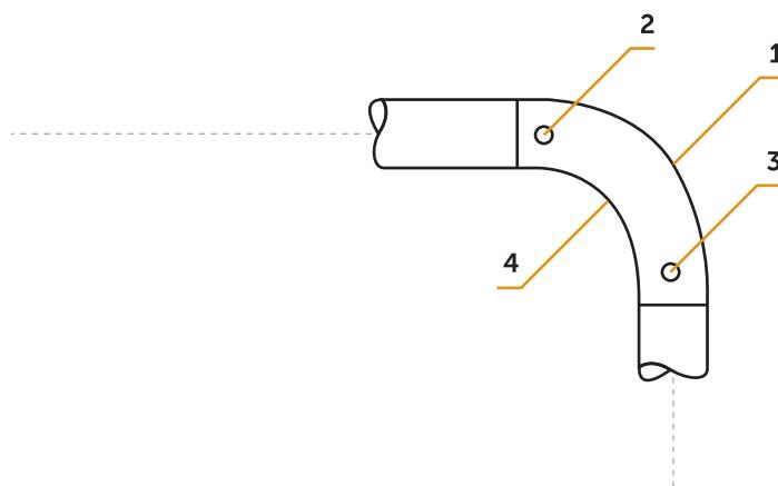
**Рисунок 9.** Это место, как самая высокая точка изделия, предназначено для выхода газов флюсования. Очевидно, что точка **1** является идеальной для удобства выхода газов, но неприемлема с точки зрения возможности бытового травматизма. Точки **2** и **3** допускают слишком большой объем газового пузыря, остающегося
