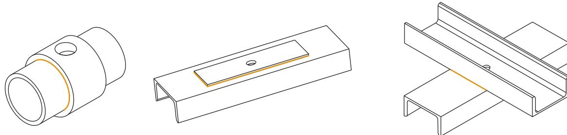
Содержание кремния и фосфора как в стали металлоконструкции, так и в присадочном электроде влияет на толщину и качество будущего цинкового покрытия. Если шов содержит много кремния, то даже будучи зачищенным заподлицо перед цинкованием, он может выступать относительно основного металла после нанесения цинкового покрытия. Высокое содержание кремния ухудшает внешний вид изделия и может привести к отслаиванию покрытия в месте шва.
