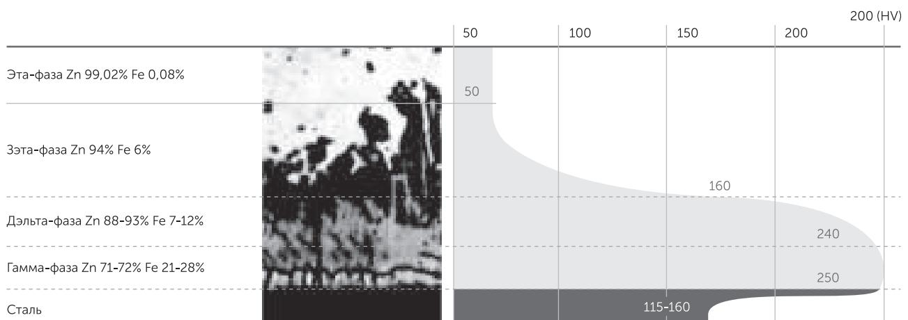
Как видно из [рисунка 3](#), микроструктура цинкового покрытия состоит из четырёх разных по твёрдости слоёв. Железо-цинковые слои.
