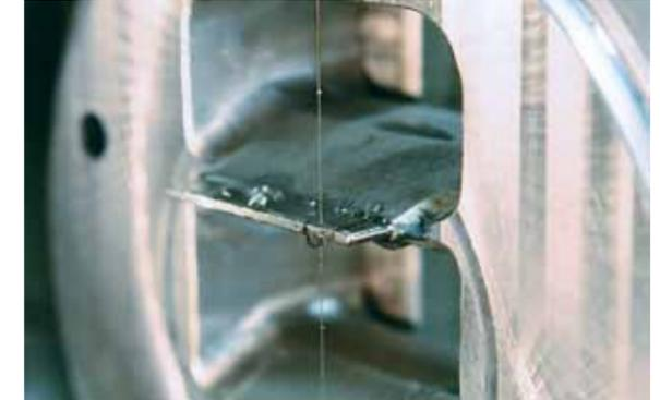
Проволочный или электроискровой метод особенно эффективен при обработке твердых материалов и сложных изделий за счет использования тонкой
