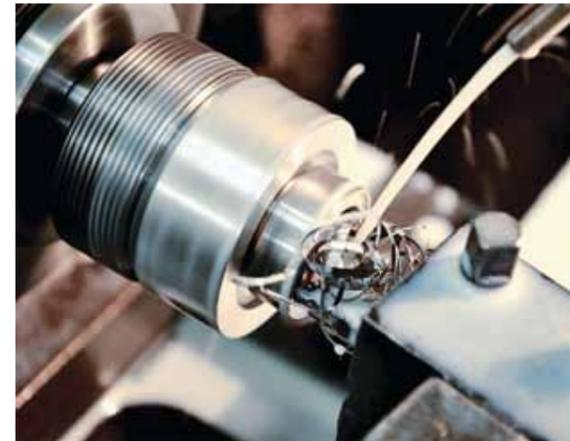
Токарная обработка ЧПУ осуществляется с применением современного режущего инструмента с твердосплавными пластинами.
